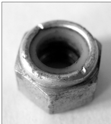
Зліва — сучасна гайка з поліуретановою шайбою, що “злетіла” з автомобільного колеса на дорозі; справа — та, що не “злітає”
